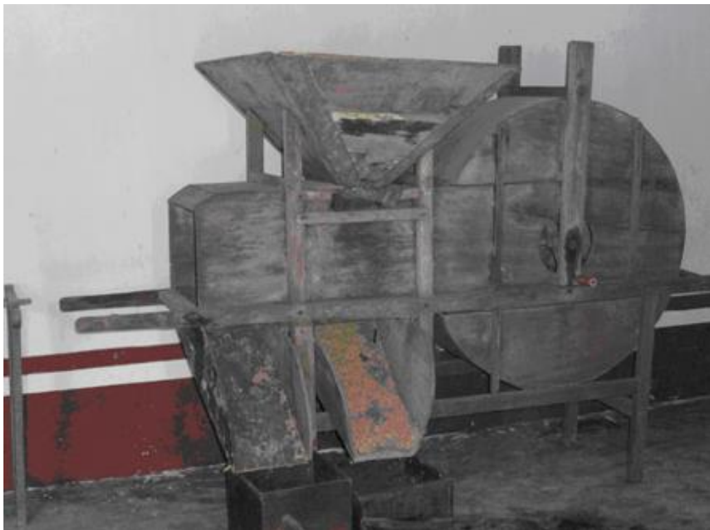
Máy rê thóc cổ truyền bằng tay. Khi không có gió thì máy rê thóc được dùng tới.
